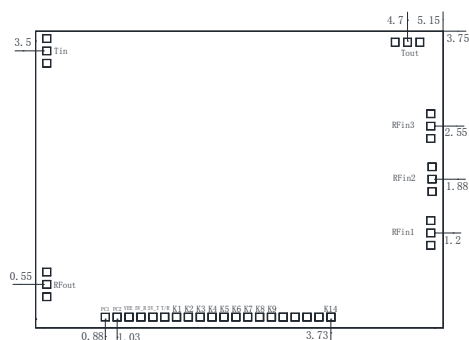
外形和端口尺寸 (mm)
